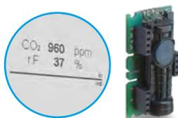
Eine ständige Messung der CO<sub>2</sub>-Werte ermöglicht es der TAC, die Lüfter entsprechend der Luftqualität zu steuern. Der Regelbereich ist einstellbar und ermöglicht die Abstimmung auf verschiedene Raumbedingungen. Das CO<sub>2</sub>-Programm kann gleichzeitig mit dem Feuchte-Temperatur-Programm eingestellt werden. Die Automatik richtet sich dann nach dem zuerst eintretenden Bedarfsfall. Bezeichnung: SCO<sub>2</sub>-TAC
